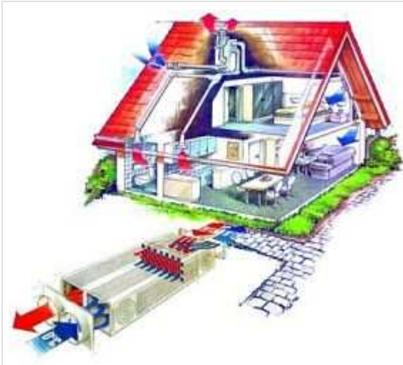
Wentylacja mechaniczna z odzyskiem ciepła
